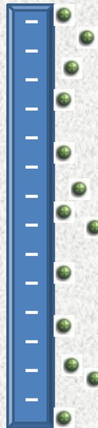
По Гуи-Чэпмену, противоионы не могут быть сосредоточены только у поверхности и образовывать монослой, а рассеяны в жидкой фазе на некотором расстоянии от границы раздела.
