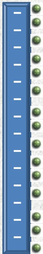
По Гельмгольцу, двойной слой представляется как бы плоским конденсатором, одна обкладка которого связана непосредственно с поверхностью твердого тела (стенкой), а другая обкладка, несущая противоположный заряд, находится в жидкости на очень малом расстоянии от первой. Потенциал в таком двойном слое должен падать линейно с расстоянием.
