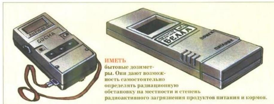
**ИМЕТЬ** бытовые дозиметры. Они дают возможность самостоятельно определять радиационную обстановку на местности и степень радиоактивного загрязнения продуктов питания и кормов.
