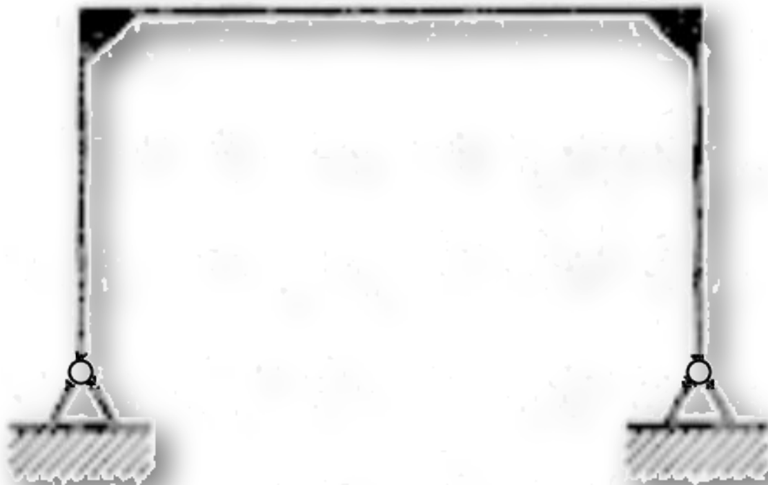
Рисунок 3 – Двухшарнирная шарнирно опертая рама
