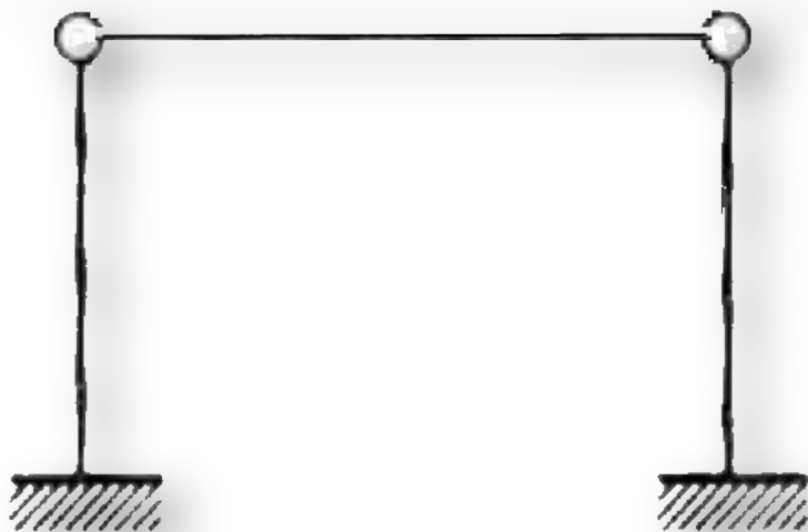
Рис. 2 Двухшарнирная жестко опертая рама
