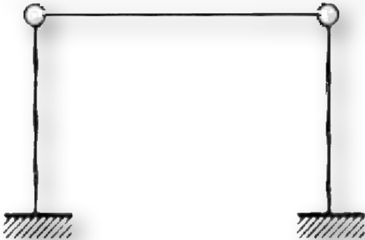
Рис. 2 Двухшарнирная жестко опертая рама
