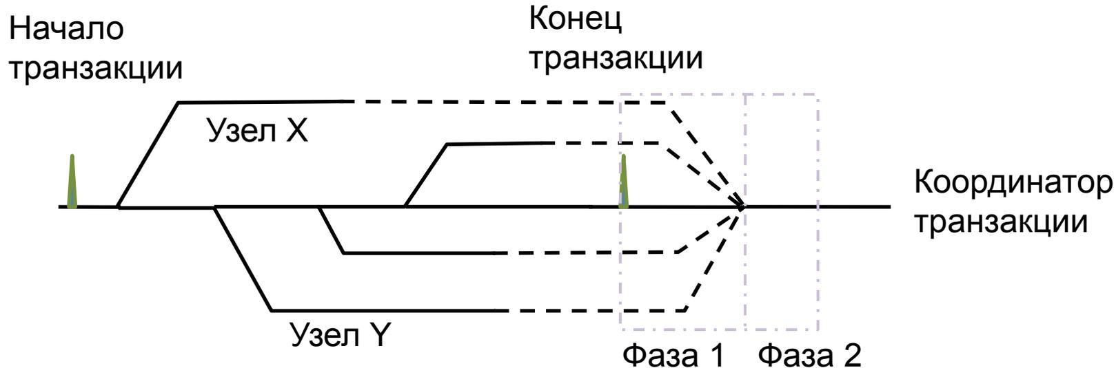
Протокол двухфазной фиксации – 2PC
