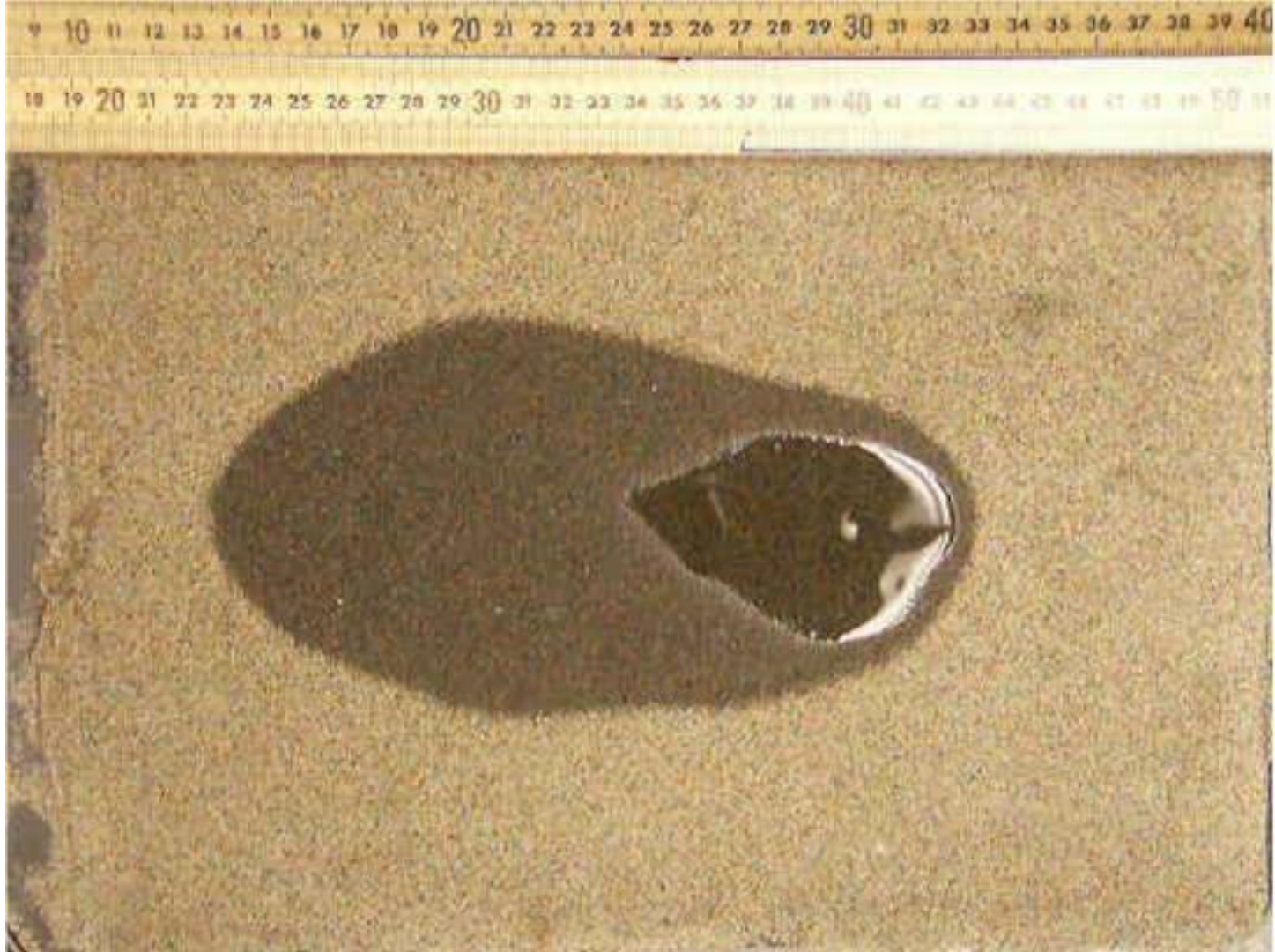
Рисунок 2.4. Пролитие кукурузного сиропа на сыром песке с наклоном 2.5 градуса. Пролитие показывают после 50 секунд, соответствующих к рисунку 2.3.
