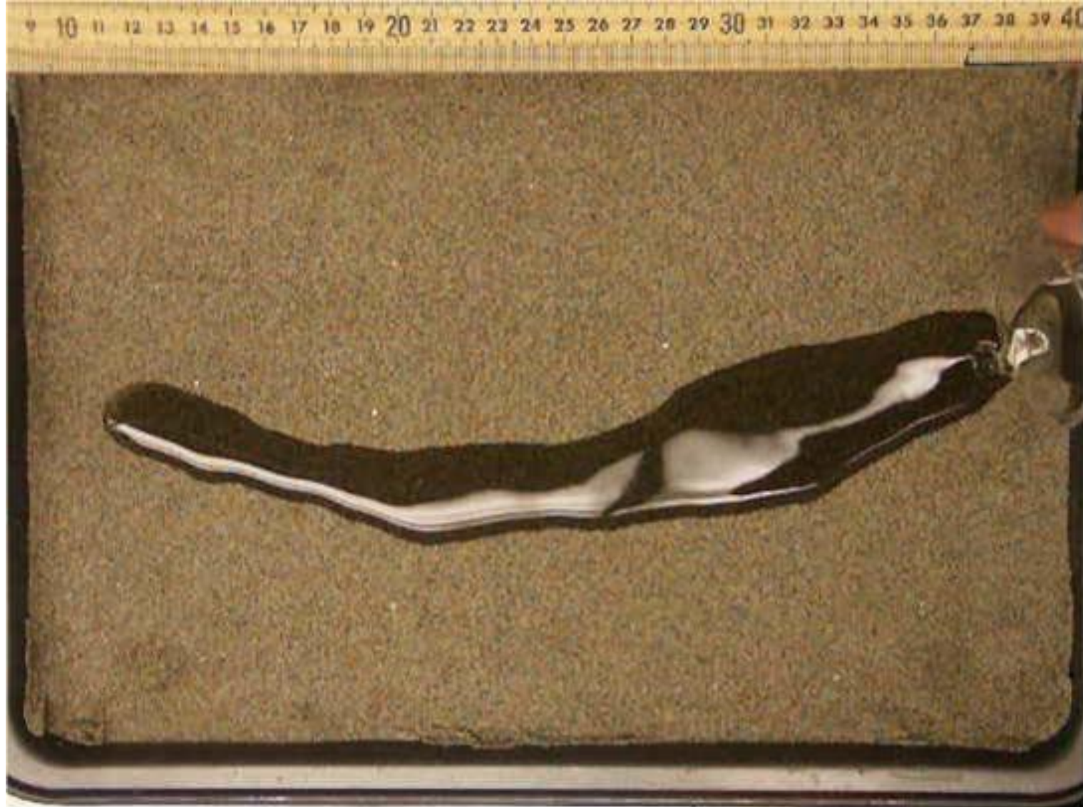
Рисунок 2.2. Пролитие Кукурузного сиропа в соотношении 3:1 с водой на сыром песке для наклона 5 градусов. Объем составляет 60 мл, которые вылили более чем 18 секунд. Изображение пролития спустя 10 секунд после того, как пролитие началось.
