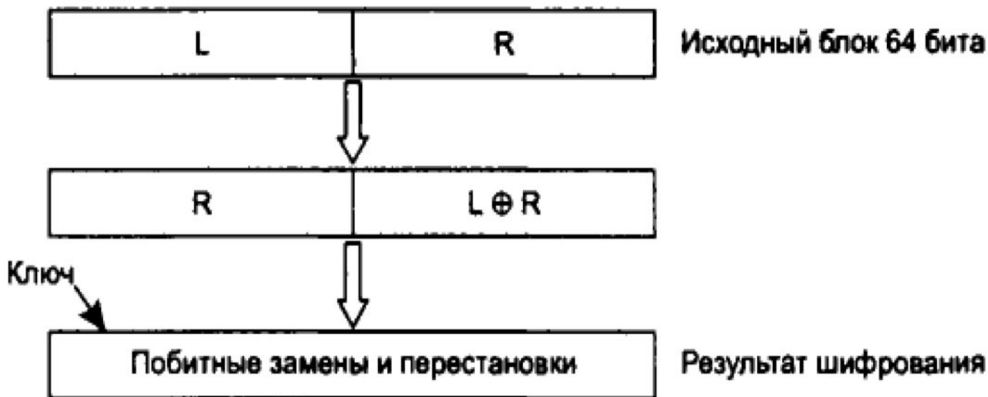
Схема шифрования по алгоритму DES
