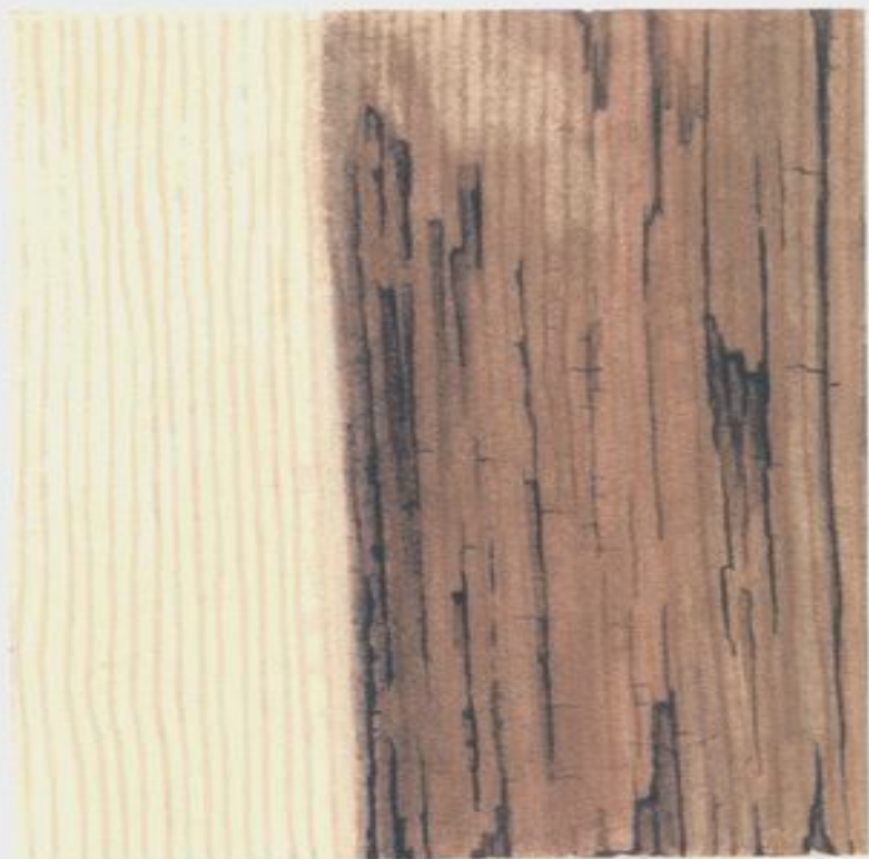
Бурая трещиноватая гниль (ель)
