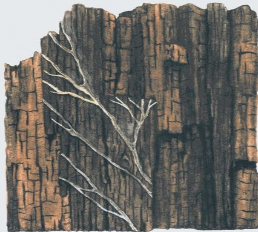
Наружная трухлявая гниль (сосна)
