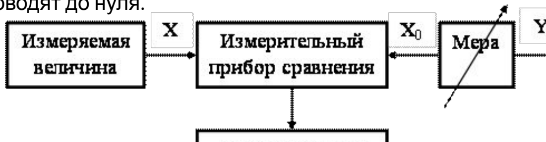
Рисунок 3 – Функциональная схема компенсационного метода измерения
