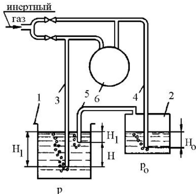
Пример 4 – Схема плотномера непрерывной продувки газа
