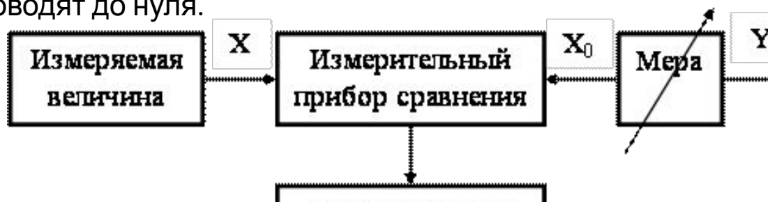
Рисунок 3 – Функциональная схема компенсационного метода измерения
