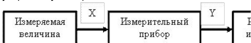
Рисунок 1 – Функциональная схема измерения методом непосредственной оценки
