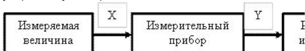
Рисунок 1 – Функциональная схема измерения методом непосредственной оценки
