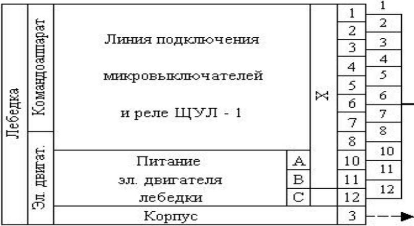
Платы подключений проводов линий внешнего монтажа элементов комплекта МПЗ - 1К
