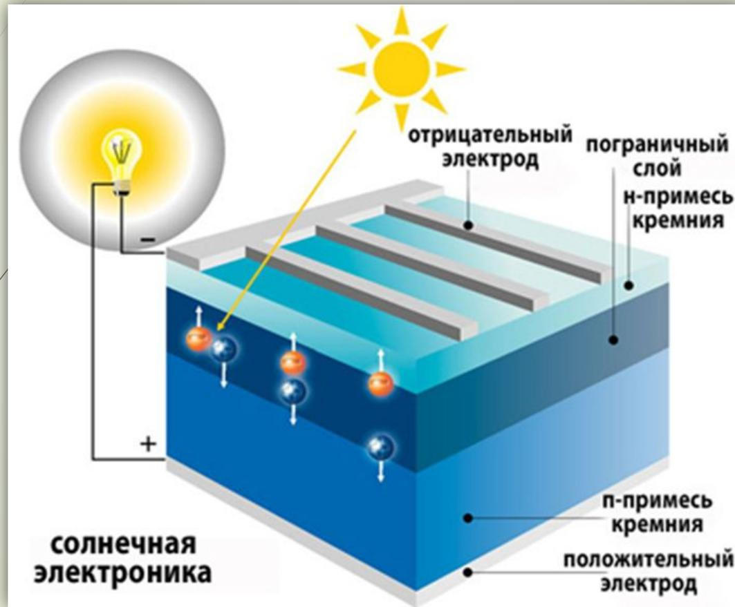
Солнечные элементы (СЭ) изготавливаются из материалов, которые напрямую преобразуют солнечный свет в электричество. Большая часть из коммерчески выпускаемых в настоящее время СЭ изготавливается из кремния.
