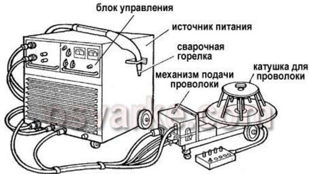
Рисунок. Компоненты сварочного полуавтомата
