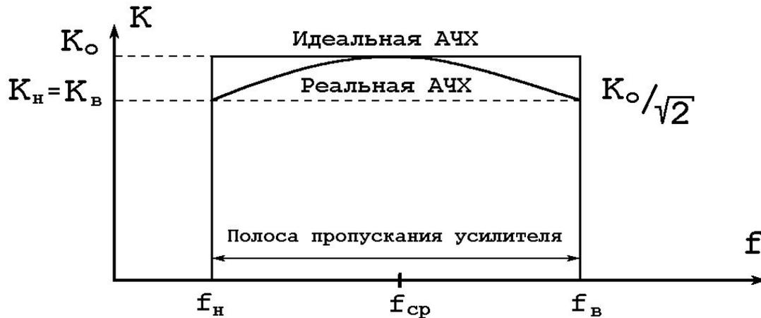
Идеальная и реальная частотная характеристика усилителя
