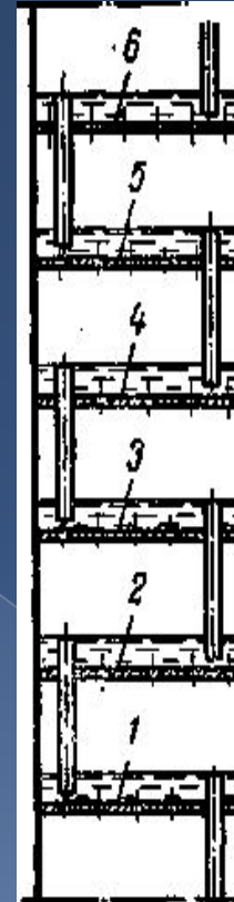
Рис. 385. Схема ректификационной тарельчатой колонны: 1, 2, 3, 4, 5, 6— тарелки колонны.
