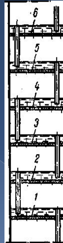
Рис. 385. Схема ректификационной тарельчатой колонны: 1, 2, 3, 4, 5, 6— тарелки колонны.
