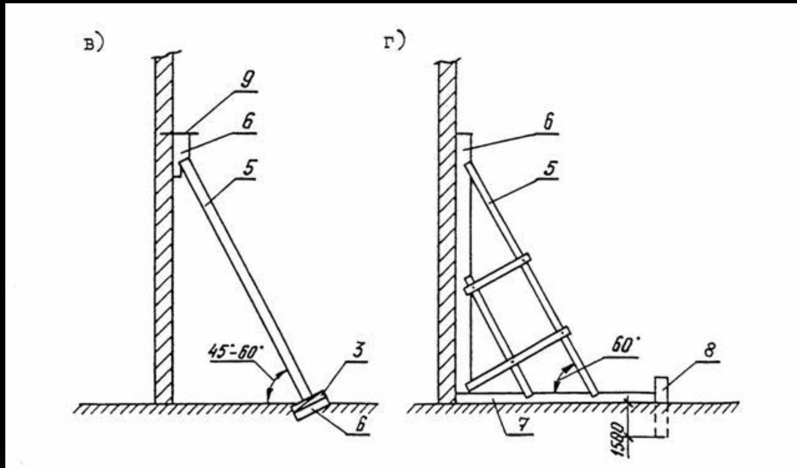
а - в виде стоек; б - пространственной опоры; в, г - подкосов для стен; 1 - конструкция; 2 - временная подпорка-стойка из бревна; 3 - клинья; 4 - пространственная опора; 5 - подкосы из бревен  $\phi$  16 - 20 см; 6 - прокладка диаметром 16 - 20 см; 7 - лежень диаметром 18 - 22 см; 8 - упорный столб диаметром 18 - 22 см; 9 - крепежный штырь.
