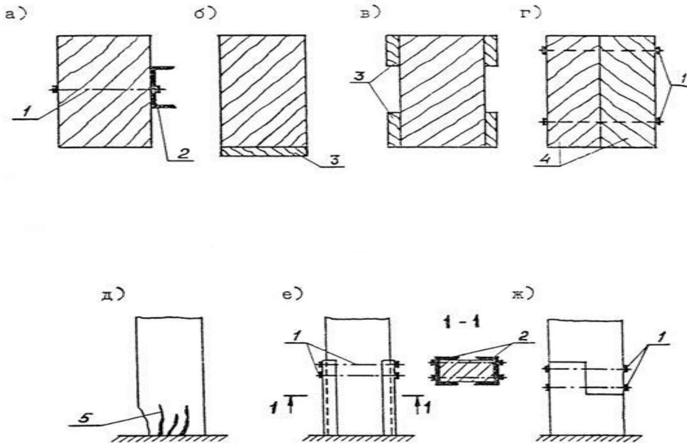
а - с помощью швеллерных профилей; б, в - с помощью накладок; г - с помощью досок или брусьев; 1 - скрепляющие болты; 2 - швеллер; 3 - накладка; 4 - доски (брусья); д - стойка с разрушенным основанием; 5 - трещины; ж - пристыковка нового основания стоек с помощью врубки вполдерева; з - заключение основания стойки в обойму из швеллерных профилей.
