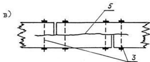
а - опоры балки; б - опорного узла врубки; в - стыкового узла балок; 1 - кладка; 2 - стальные уголки усиления; 3 - скрепляющие болты; 4 - балка; 5 - трещина.
