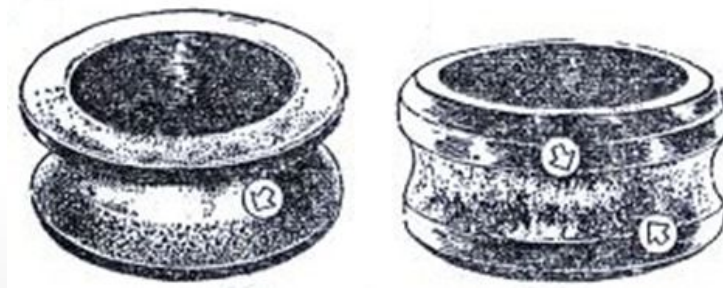
Дефекты подшипников качения
