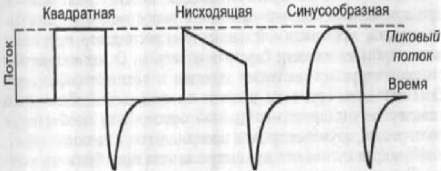
Рис. 6.5. Формы потока вдоха при проведении вентиляции по объему.
