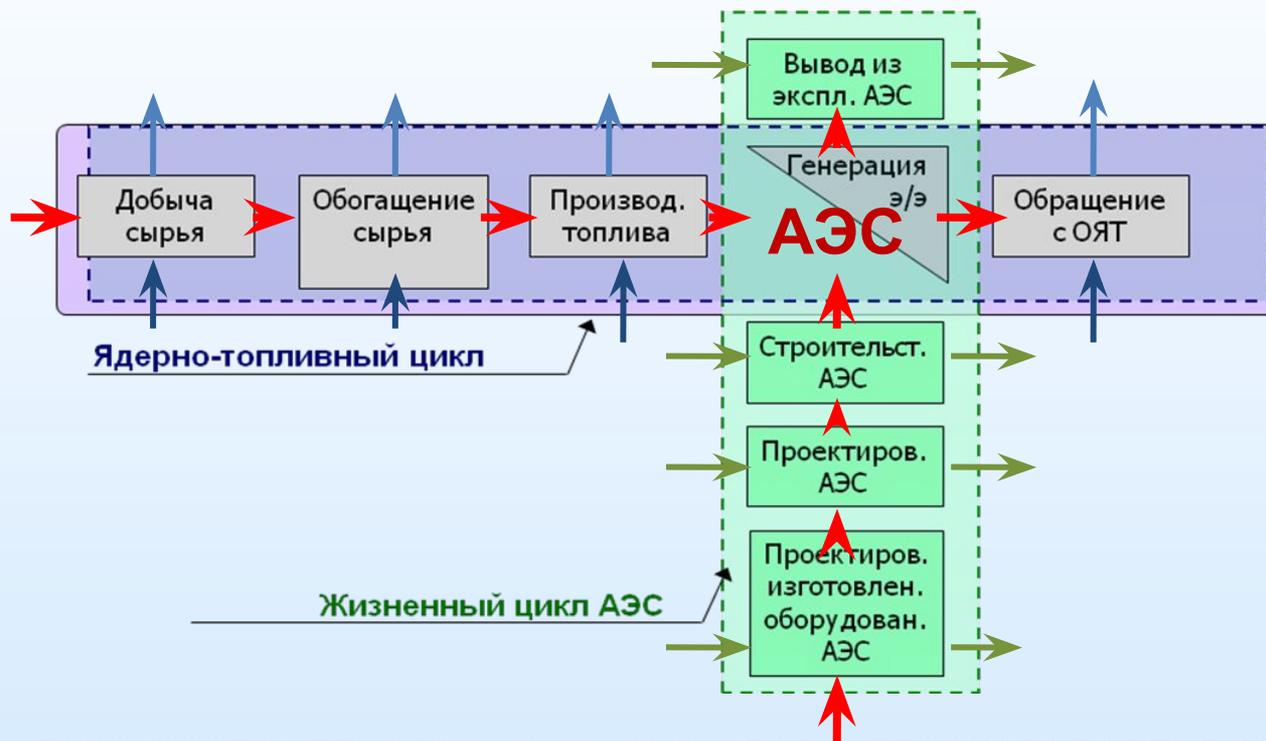
**АЭС как «перекресток двух жизненных циклов»: ядерного топливного цикла и машиностроительного цикла АЭС.**
