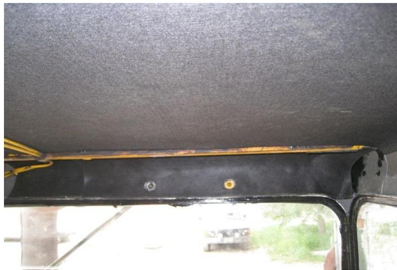
Передняя панель с установленной шумоизоляцией и крыша кабины с шумопоглощающим слоем
