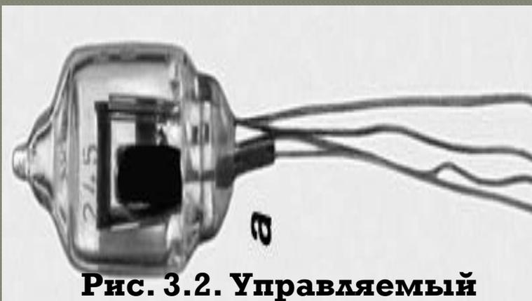
**Рис. 3.2. Управляемый разрядник в стеклянном корпусе.**
