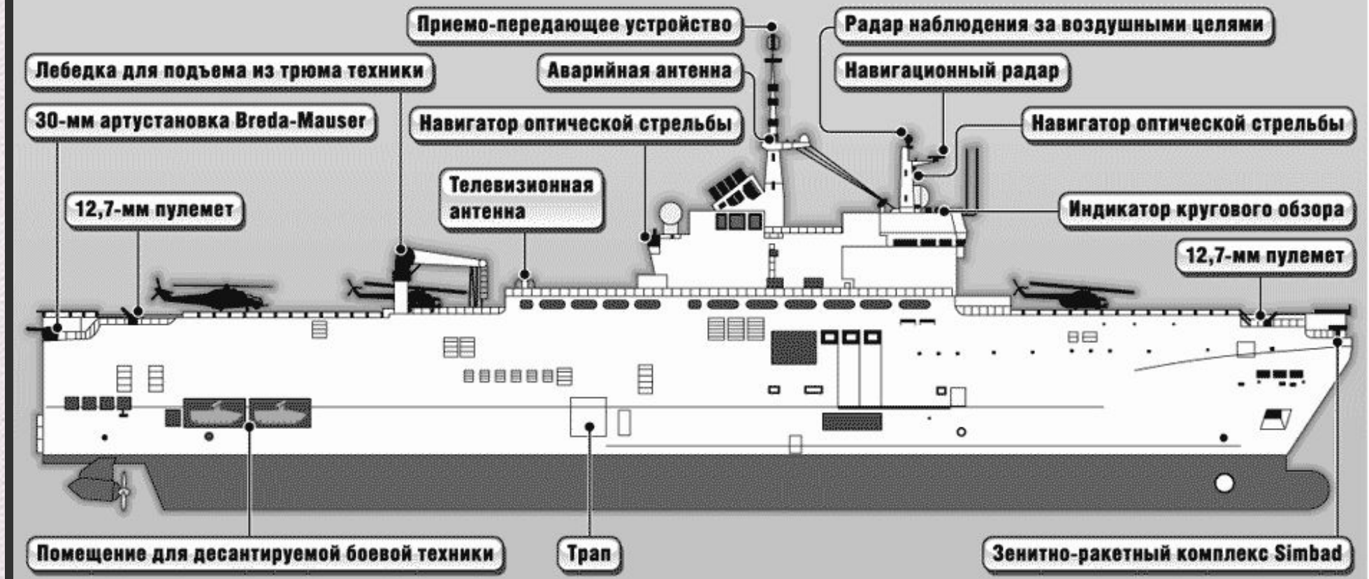
(На фото схема вертолетоносца класса «Мистраль»)
