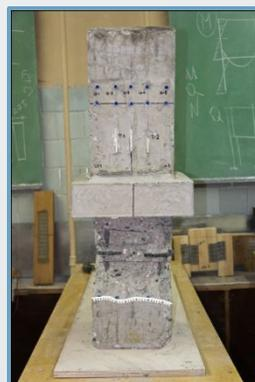
Испытания позволили разработать методики расчета прочности и деформативности штепсельных стыков плит с колоннами, необходимые для проектирования и внедрения сборной железобетонной несущей системы **УИКСС**.
