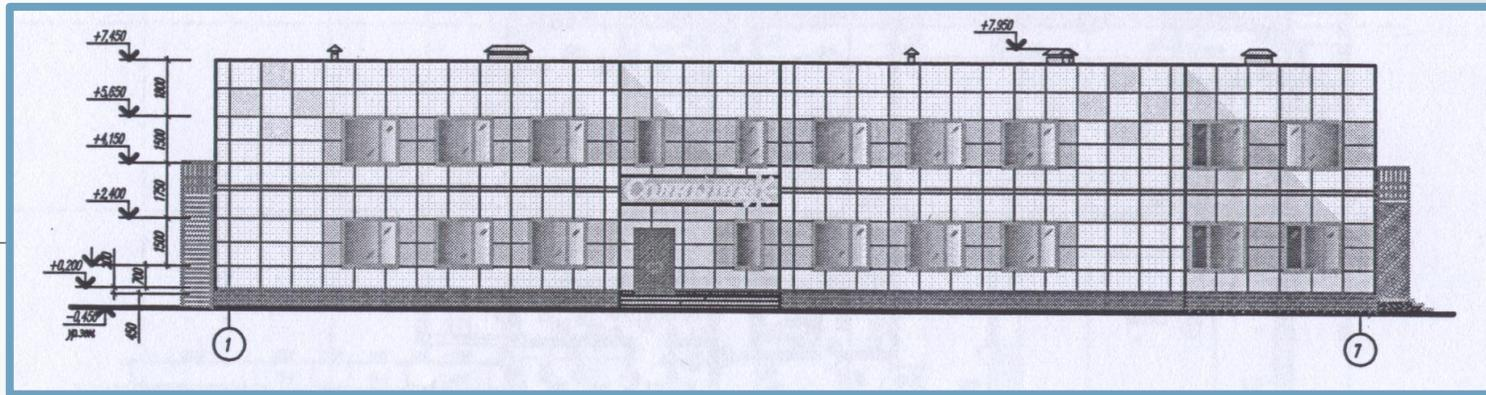
Использование несущей каркасной системы обеспечивает не только свободную планировку помещений, но и позволяет получить до 40 м<sup>2</sup> дополнительной площади за счет удаления внутренних массивных несущих стен.
