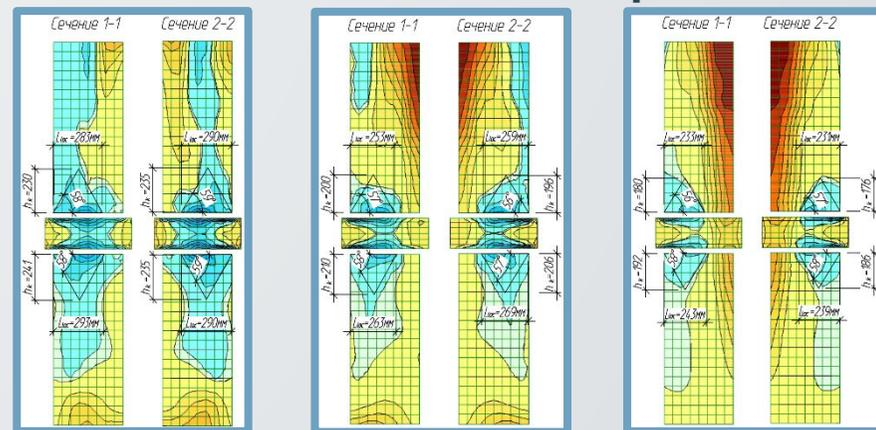
Возможные схемы разрушения
