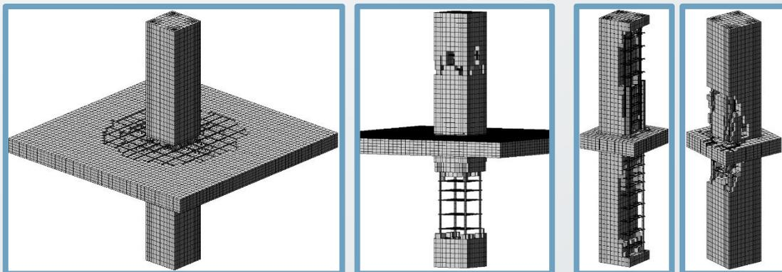
Компьютерное моделирование позволило получить необходимые данные о НДС стыка плита-колонна при варьировании факторами и действии различных комбинаций и соотношений нагрузок, а также оптимизировать программу проведения экспериментальных исследований.
