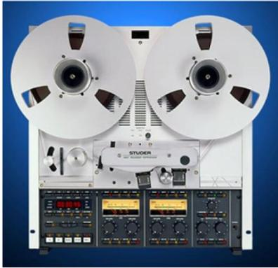
Сигнал с микрофона записывается на магнитную ленту со всеми частотами. Магнитофон считывает записанное с ленты, усиливает и отправляет в динамики.
