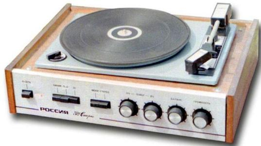
Другой способ аналоговой записи — виниловые пластинки. На них вырезаются тонкие дорожки, а считывающая игла колеблется именно с частотами, которые были у исходного звука. Колебания преобразуются в электрические, усиливаются и отправляются на динамики.
