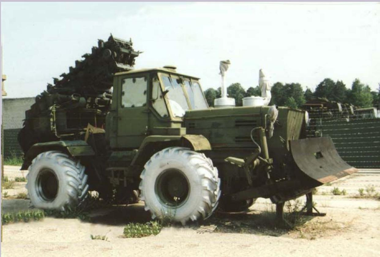
Масса – 12,8 т. База трактор Т-155 и рабочее оборудование.
