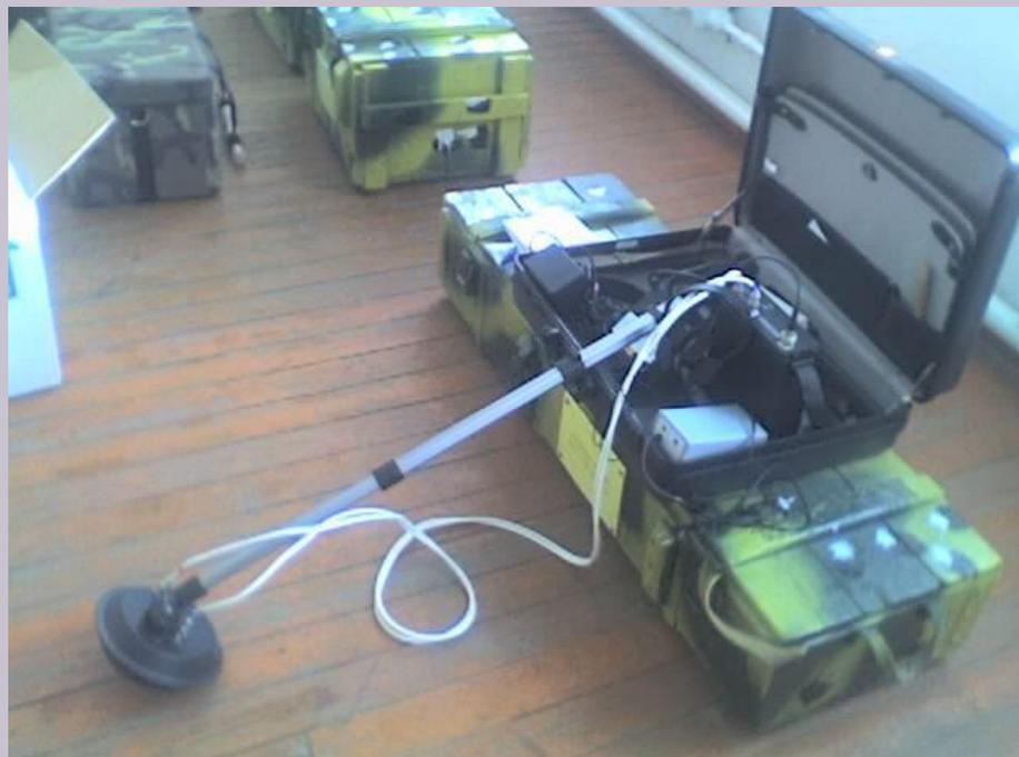
**Изделие предназначено** для поиска радиоэлектронных технических средств, содержащих полупроводниковые компоненты, независимо от их функционального состояния, т.е. находящихся как во включенном, так и в выключенном состоянии.
