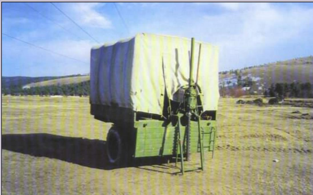
Предназначена для добычи грунтовых вод путем устройства временных скважин в грунтах до IV категории буримости включительно, а также для очистки воды поверхностных и подземных источников
