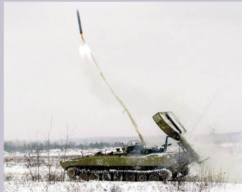
Предназначена для проделывания проходов в противотанковых минных полях взрывным способом.
