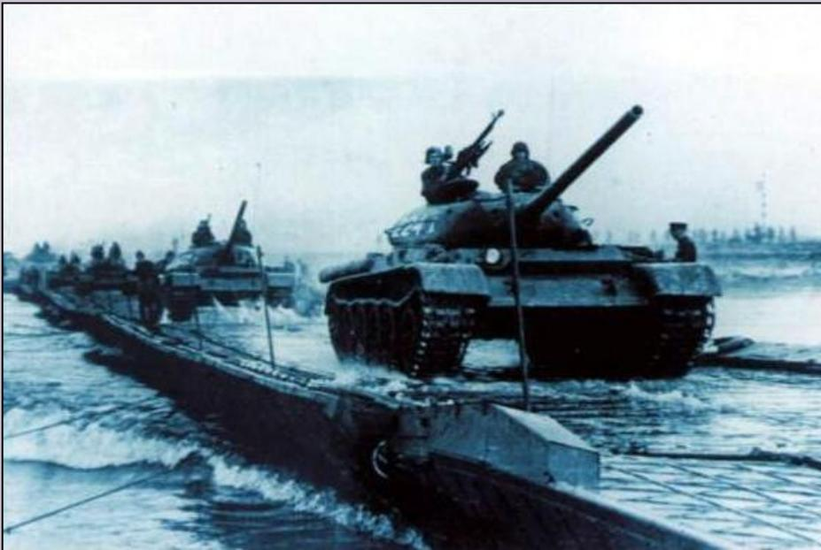
Предназначена для оборудования мостовых и паромных переправ через водные преграды.
