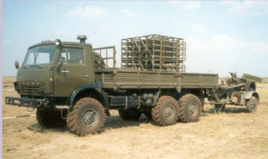
Предназначена для механизированной установки противотанковых и противопехотных мин в ходе боя в грунт (снег) с маскировкой и на поверхность грунта (снега).
