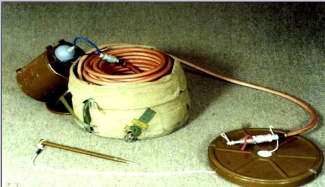
Предназначен для проделывания проходов в противопехотных минных полях.
