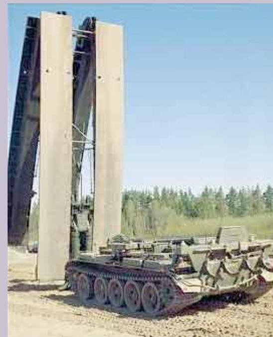
**Танковый мостокладчик МТ-55 предназначен для наведения однопролетного металлического моста грузоподъемностью 50 тонн через препятствия шириной до 17 метров. Наведение моста осуществляется экипажем машины без выхода личного состава из машины.**
