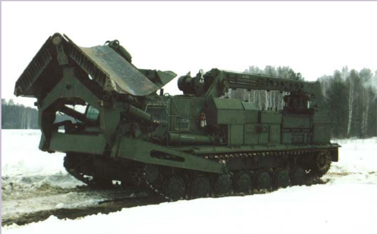
Предназначен для механизации различных работ, может быть использован при проведении аварийно-спасательных работ в зонах массовых разрушений. Наличие крана, лебедки, рыхлителя значительно расширяет возможности применения машины. Простота в управлении и обслуживании, высокая маневренность позволяют использовать машину в условиях бездорожья.
