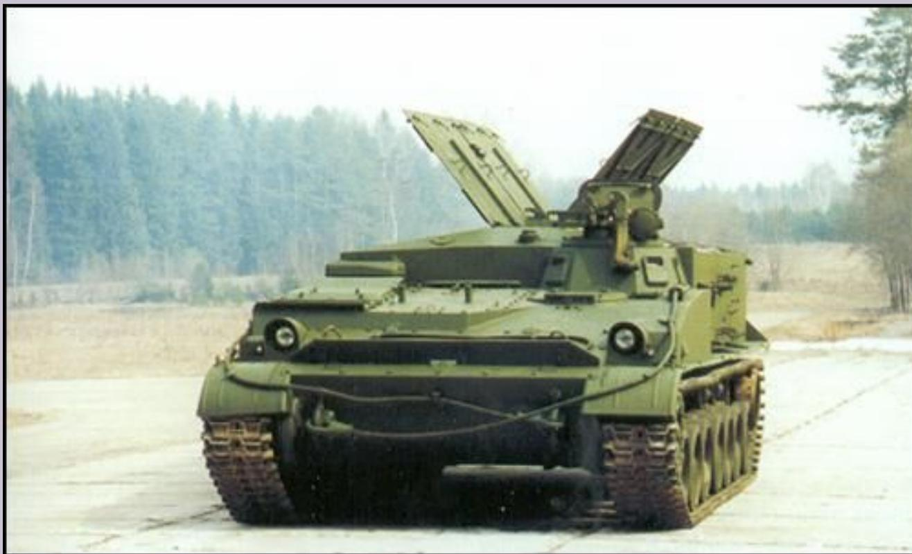
**Ветер-Г предназначен для ускоренного минирования противотанковыми, противопехотными минами кассетного снаряжения в наброс.**
