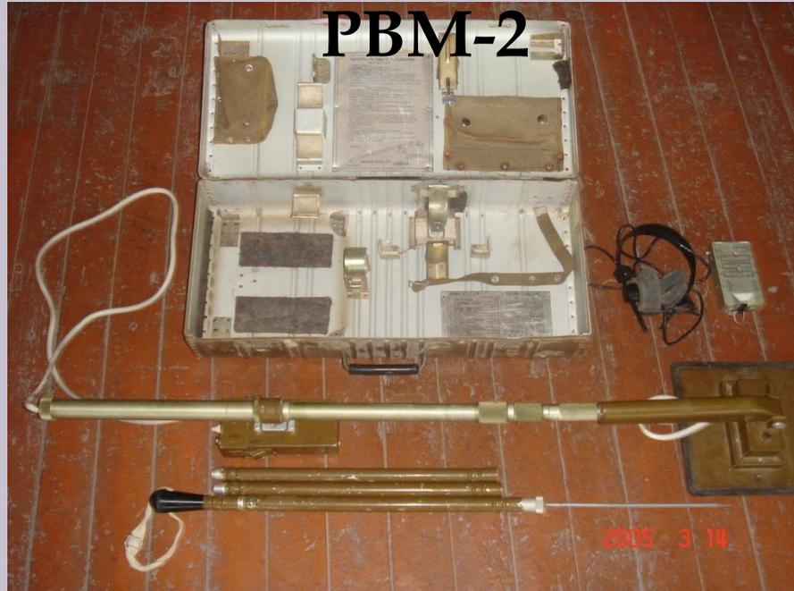
**Радиоволновый миноискатель RBM-2** предназначен для поиска противотанковых и противопехотных мин, установленных в грунт (снег), корпуса или взрыватели которых изготовлены из металла.
