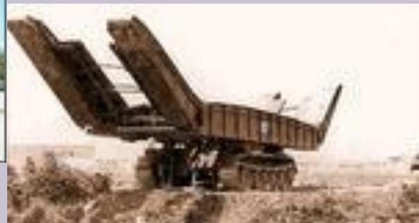
Танковый мостоукладчик МТУ-20 предназначен для наведения однопролетного металлического моста грузоподъемностью 50 тонн через препятствия шириной до 18 метров. Наведение моста осуществляется экипажем машины без выхода личного состава из машины.
