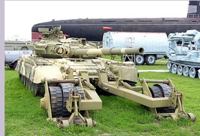
Предназначен для обеспечения преодоления танками противотанковых минных полей и прodelывания в них колeйных проходoв.
