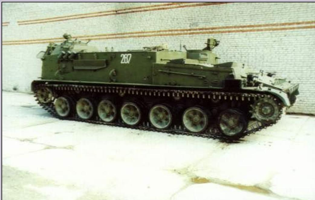
Предназначена для механизированной установки противотанковых мин в ходе боя в грунт (снег) с маскировкой и на поверхность грунта (снега).
