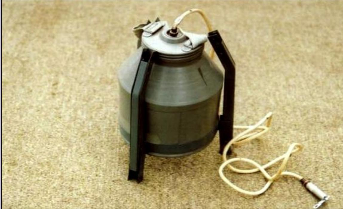
Предназначен для пробивания железобетонных и броневых толщ различных сооружений, пробивания шпуров в бетоне, железобетоне и мерзлом грунте, повреждения военной и промышленной техники, уничтожения боеприпасов.
