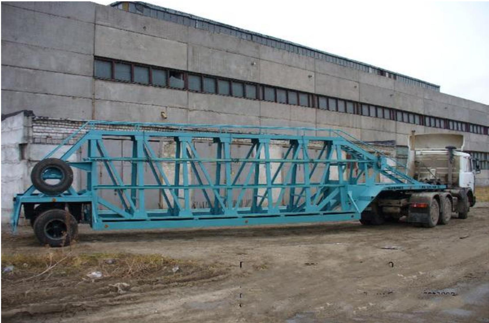
**3. Специальные автотранспортные средства**-машины, предназначенные для транспортирования определённых видов грузов и оборудованные специальными устройствами для выполнения дополнительных не транспортных операций (смешивание, подогрев и т.п.) для обеспечения сохранности грузов.
