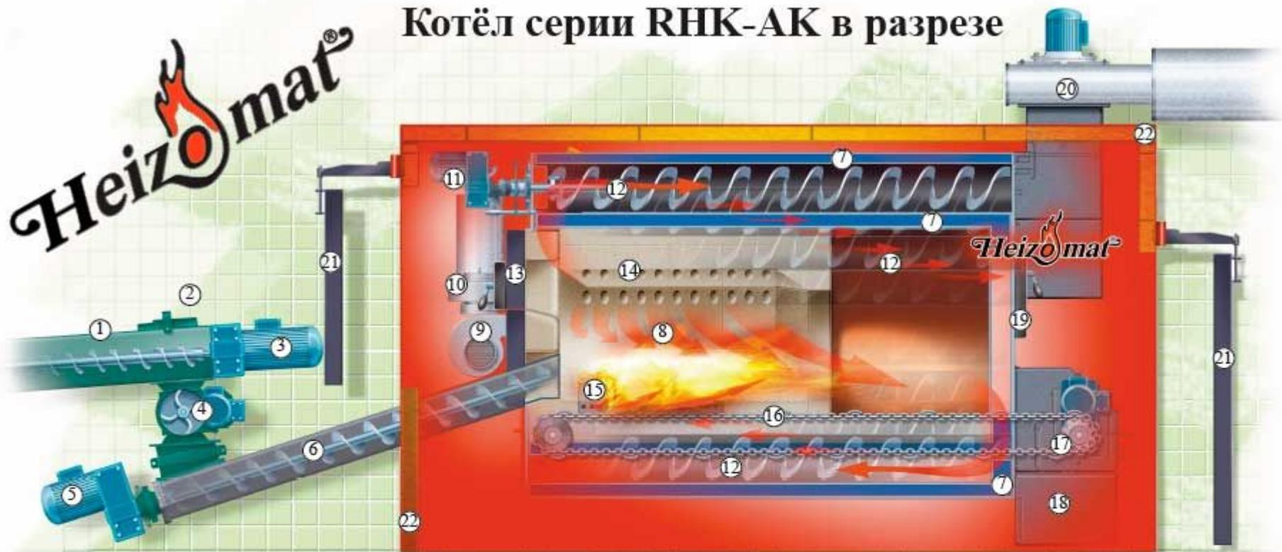
1. Закрытый канал подачи материала со встроенным шнеком
