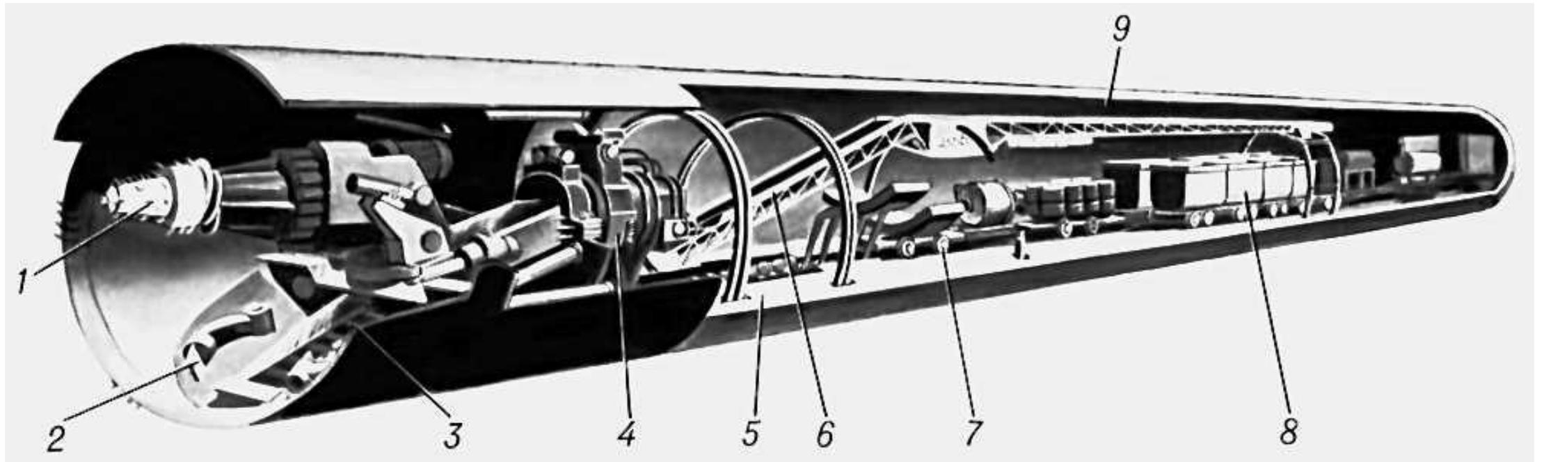
Сооружение тоннелей щитовым комплексом: 1 — исполнительный орган; 2 — погрузочный орган; 3 — щит; 4 — блокоукладчик; 5 — передвижная платформа; 6 — перегружатель; 7 — блоковоз; 8 — вагонетки; 9 — блочная крепь.
