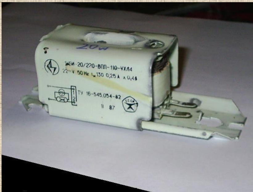
Электромагнитный балласт «1УБИ20» серии 110 завода ВАТРА, СССР.
