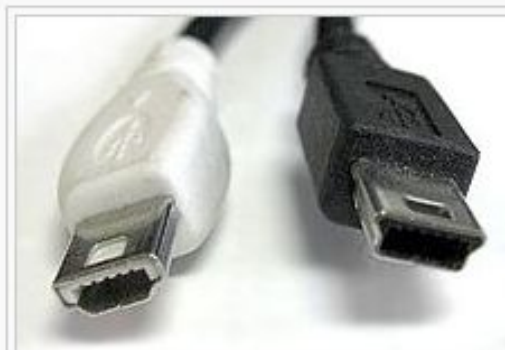
Mini USB Тип А (слева) и Mini USB Тип В (справа)
