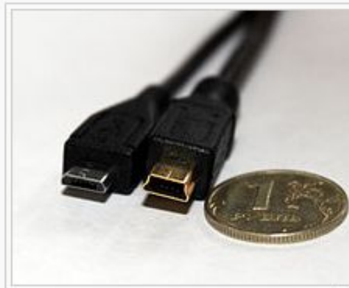
Micro USB Тип В (слева) в сравнении с Mini USB Тип В (справа)
