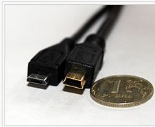
Micro USB Тип В (слева) в сравнении с Mini USB Тип В (справа)
