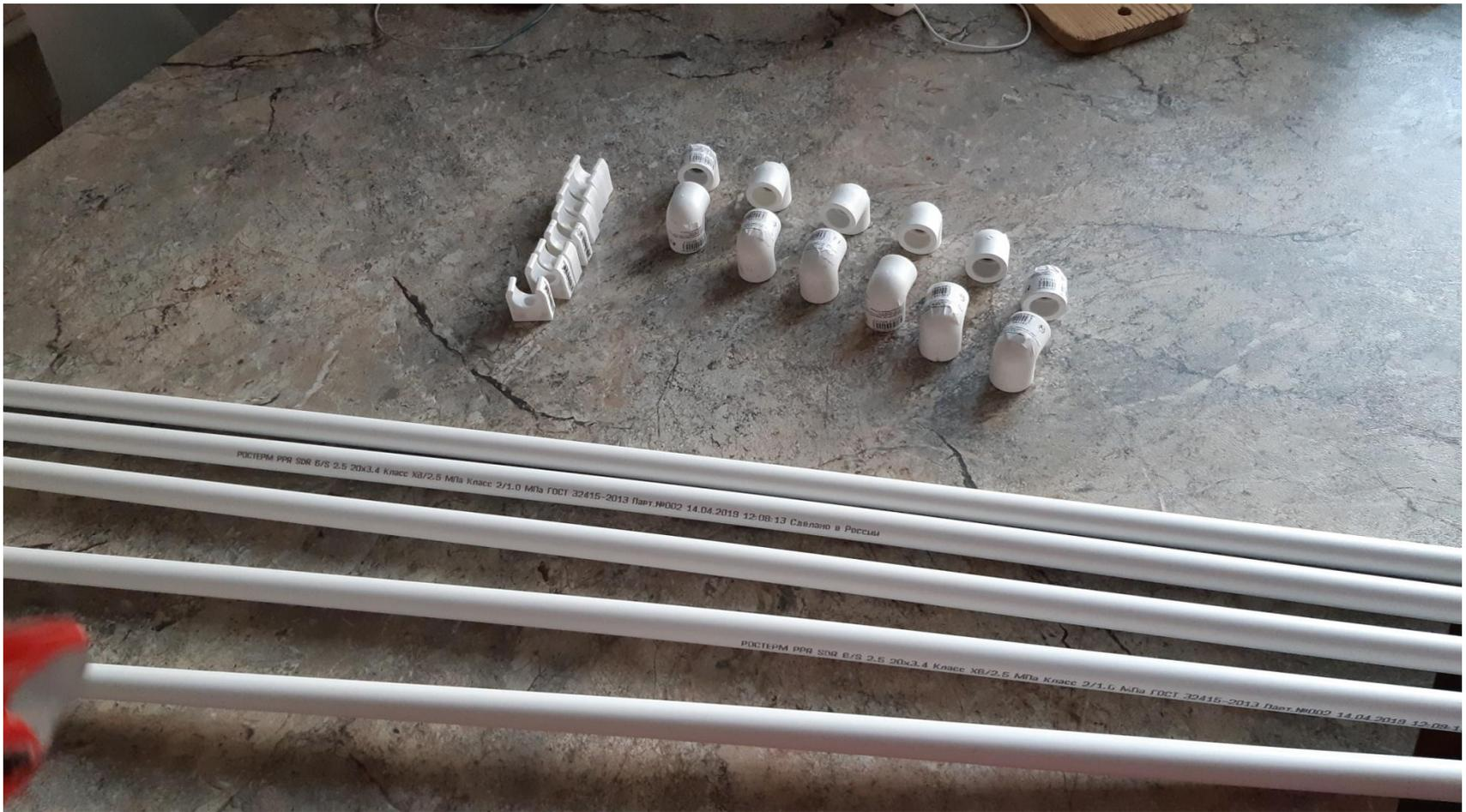
Разрезать трубы на отрезки по 50 и 100 см (по 6 шт каждые)
