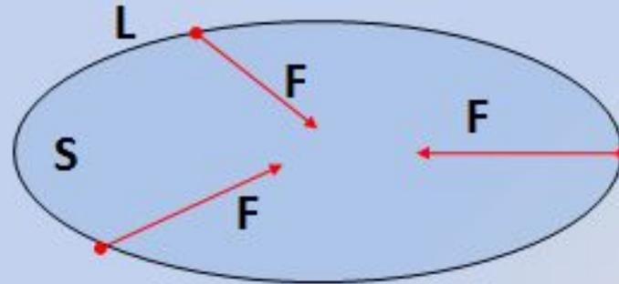
Энергия поверхностного натяжения равна произведению коэффициента поверхностного натяжения на площадь свободной поверхности жидкости.
