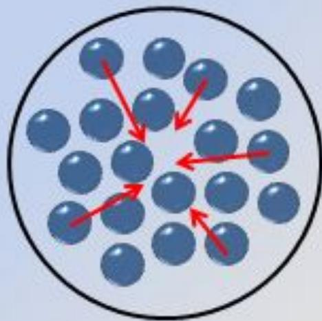
*Силы поверхностного натяжения – причина шаровидной формы капли воды*
