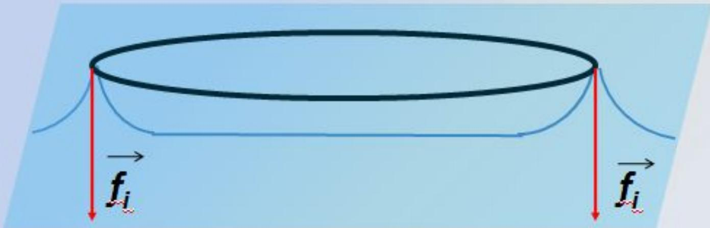
В момент отрыва кольца сила поверхностного натяжения будет равна внешней вертикальной силе, действующей на кольцо, и равна произведению удвоенной длины кольца на коэффициент поверхностного натяжения.
