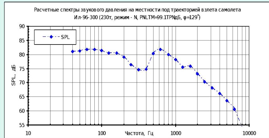
LA, дБА – максимальный суммарный по спектру уровень звукового давления, скорректированный по шкале «А» стандартного шумометра. Метод частотного взвешивания учитывает разную чувствительность человеческого уха к звуку различной частоты.
