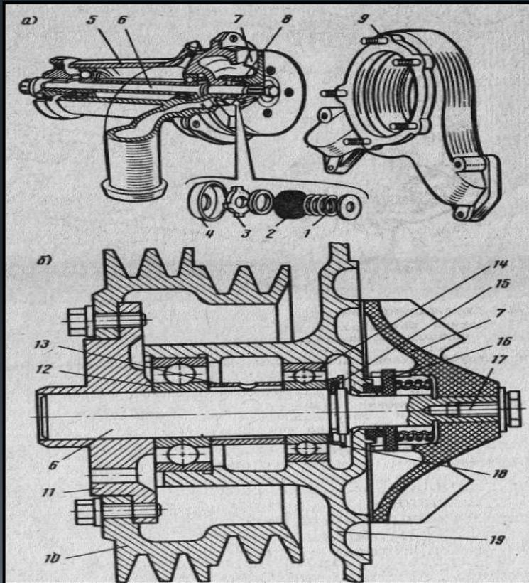
Водяные насосы двигателя ЗИЛ-130(а) и двигателя ЗИЛ-645(б)
