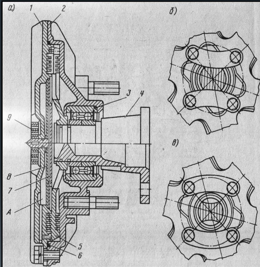
Гидромуфта вентилятора двигателя ЗИЛ-645
