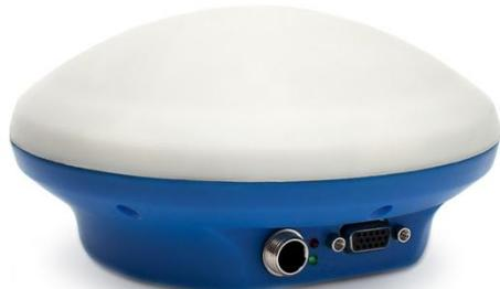
В комплекте системы ГеоТрек Эксплорер поставляется patch антenna/приемник. Уровень точности, с которым, достигается порядка 30-40 см на бесплатном сигнале. По умолчанию частота обновления – 2 Гц. Программно частота может быть повышена до 5 Гц.
