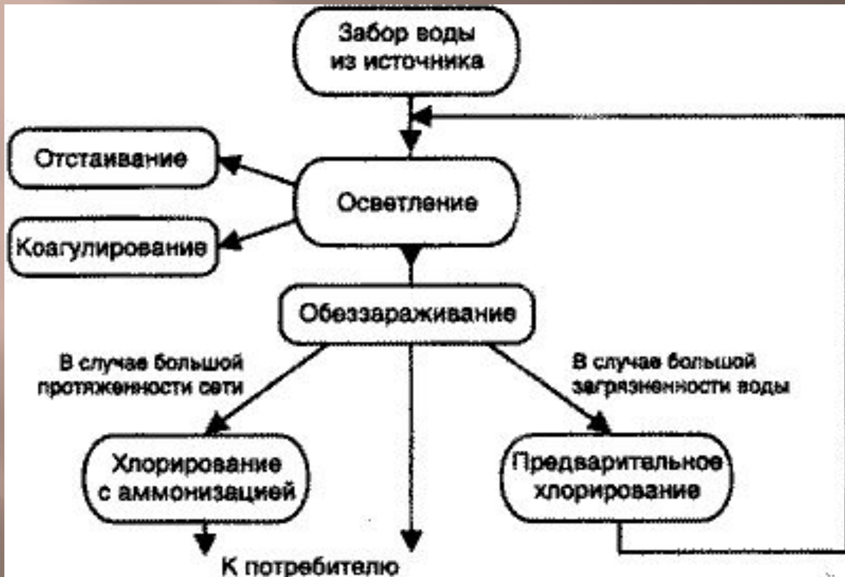
Основные технологические процессы обработки воды [2]
