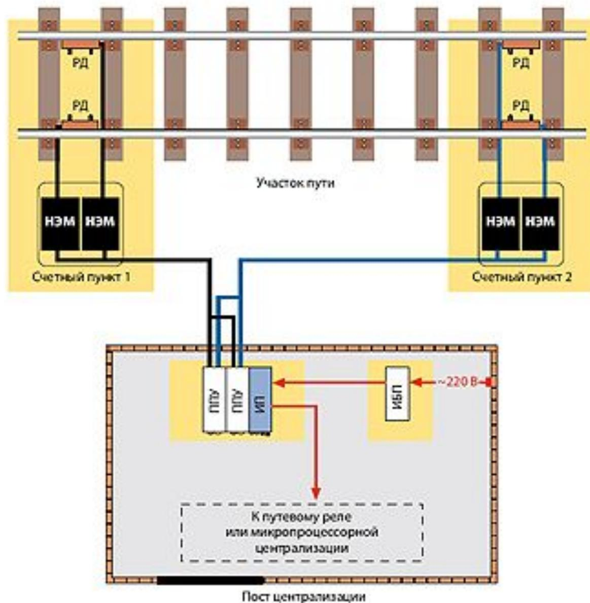
Рис. 1. Пример размещения компонентов системы ЭССО на неразветвленном участке пути:
