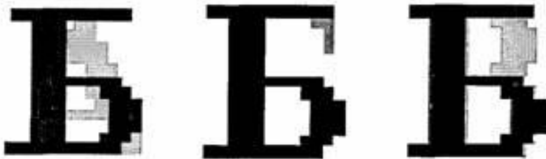
Рис. 3.16. Распознаваемый символ «Б» накладывается на растровые шаблоны символов (А, Б, В и т. д.)
