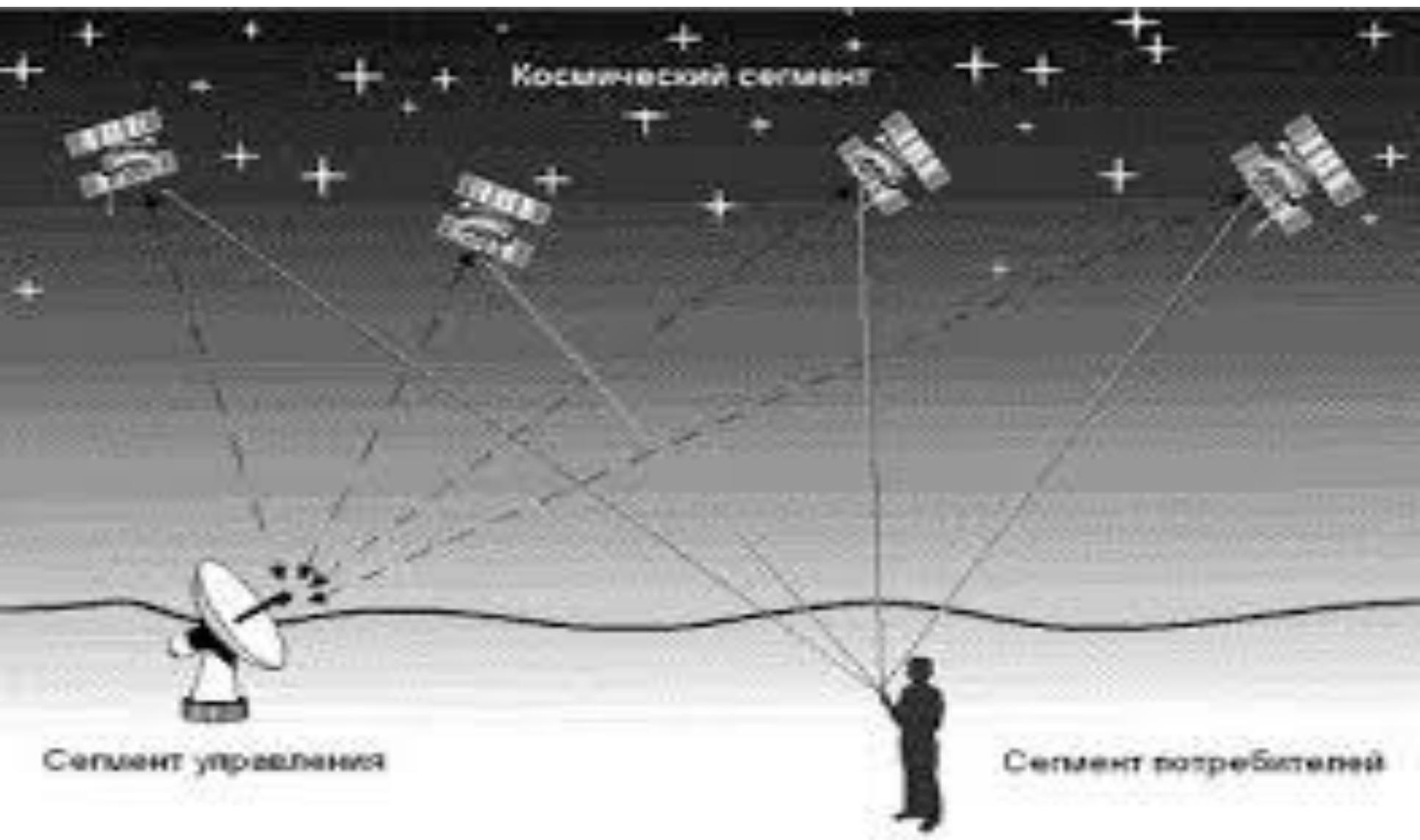
*Космический сегмент* включает 24 спутника, излучающих непрерывные радионавигационные сигналы, которые формируют сплошное радионавигационное поле на поверхности Земли и околоземном пространстве.
