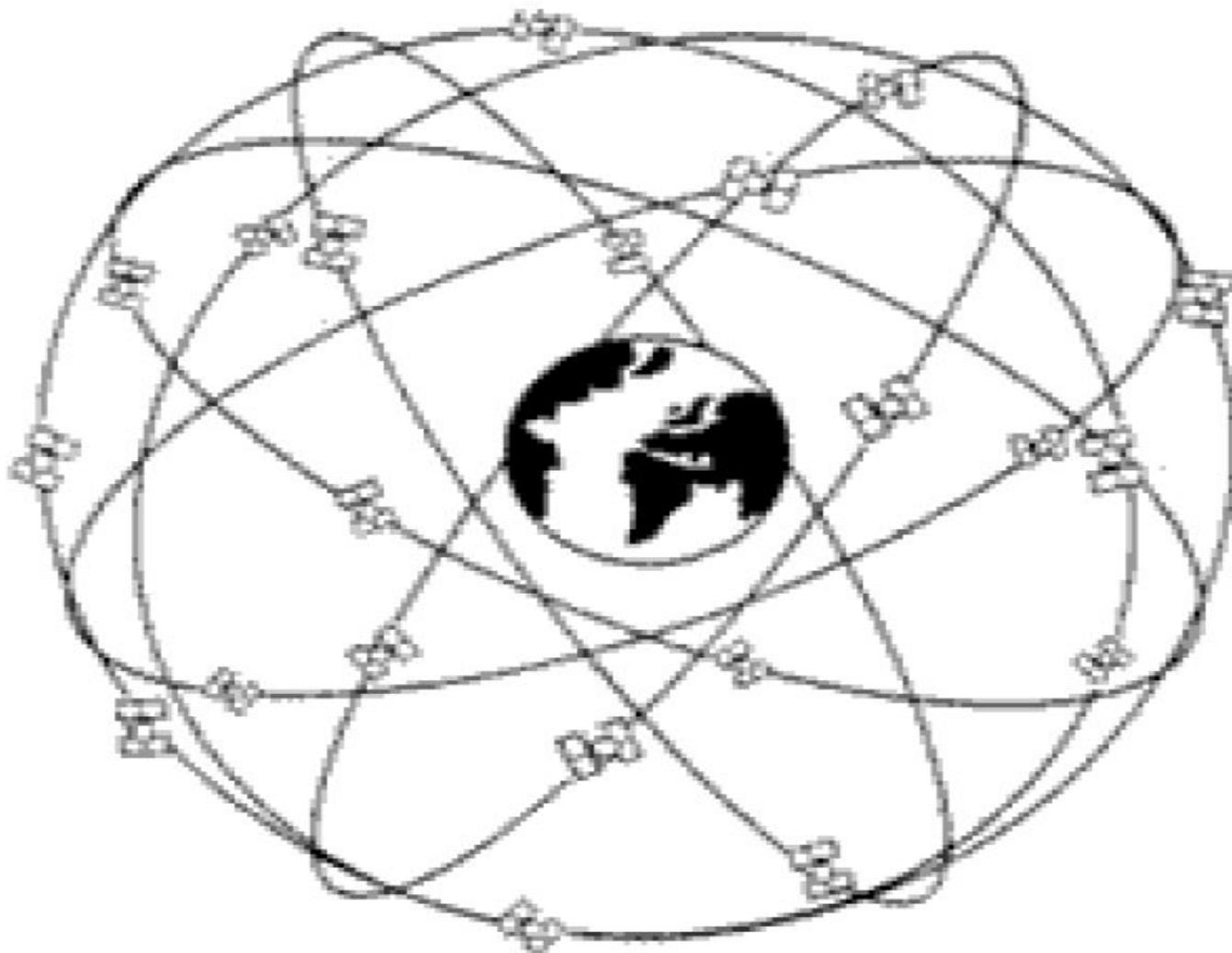
Орбитальная группировка GPS состоит из 28 навигационных космических аппаратов. Все они находятся на круговых орбитах с периодом обращения вокруг Земли равным 12 часам. Высота орбиты каждого спутника примерно равна 20 тыс. км.
