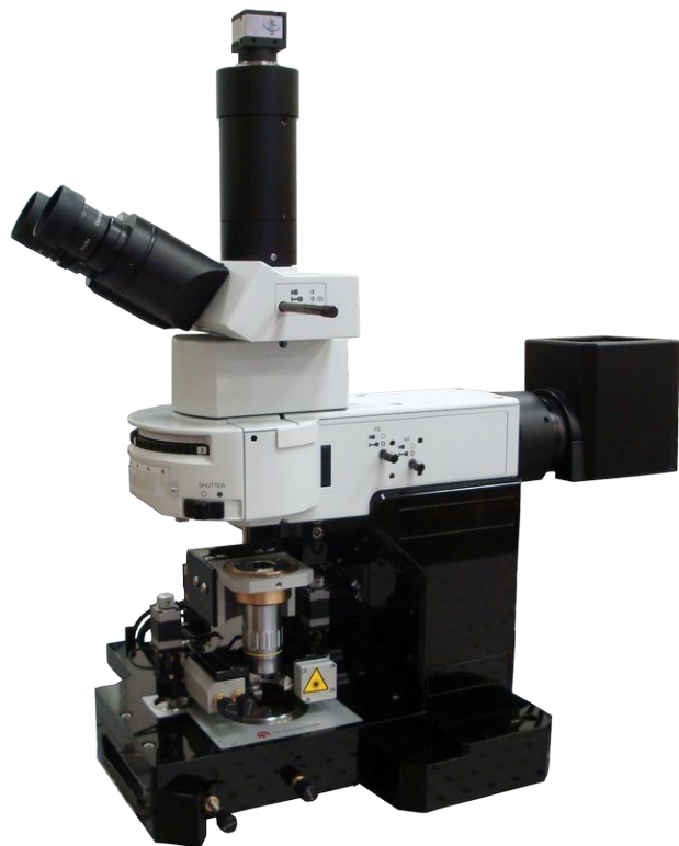
Certus Optic U - интегрированные атомно-силовой (АСМ) и прямой оптический микроскопы
