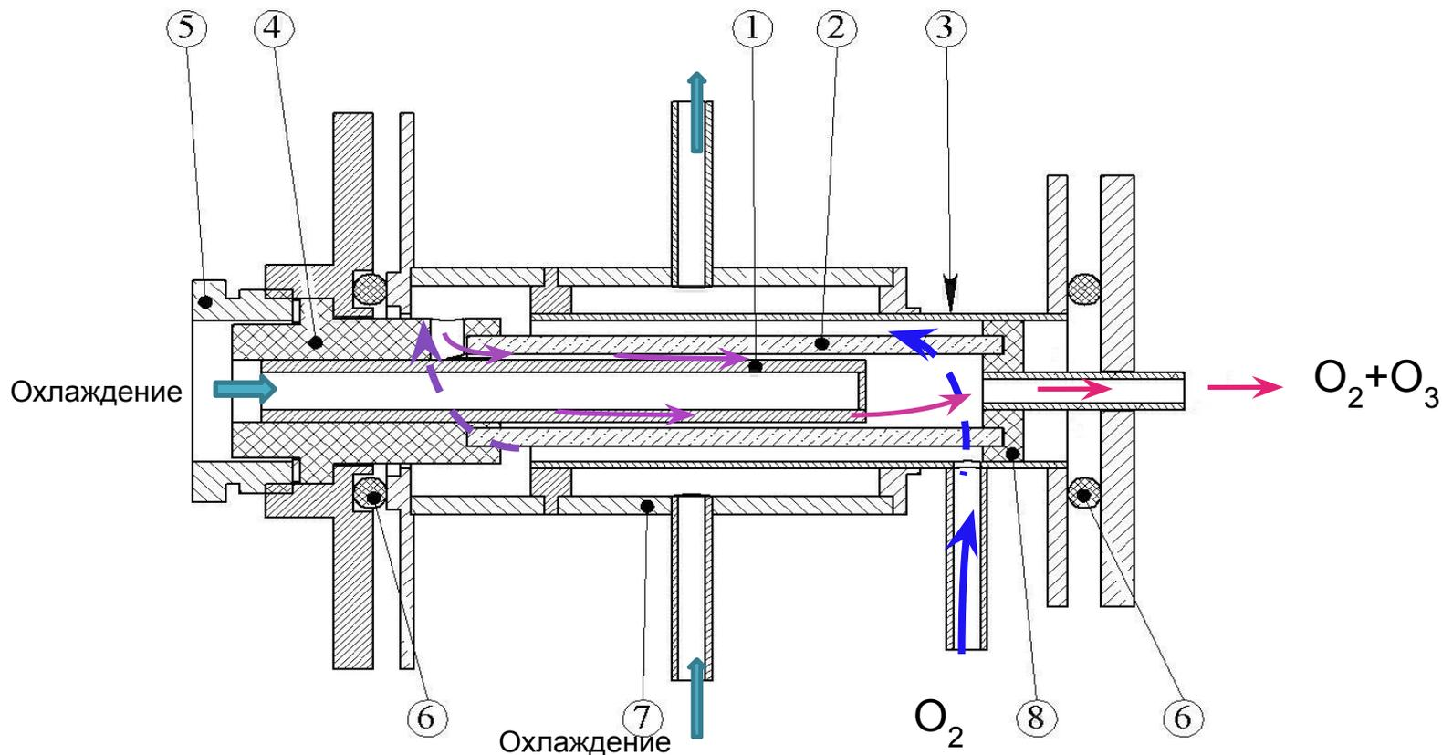
1 – внутренний электрод, 2 – диэлектрик, 3 – внешний электрод, 4 – фторопластовое уплотнение, 5 – гайка уплотнения, 6 – уплотнение, 7 – рубашка охлаждения, 8 – центровочное кольцо
