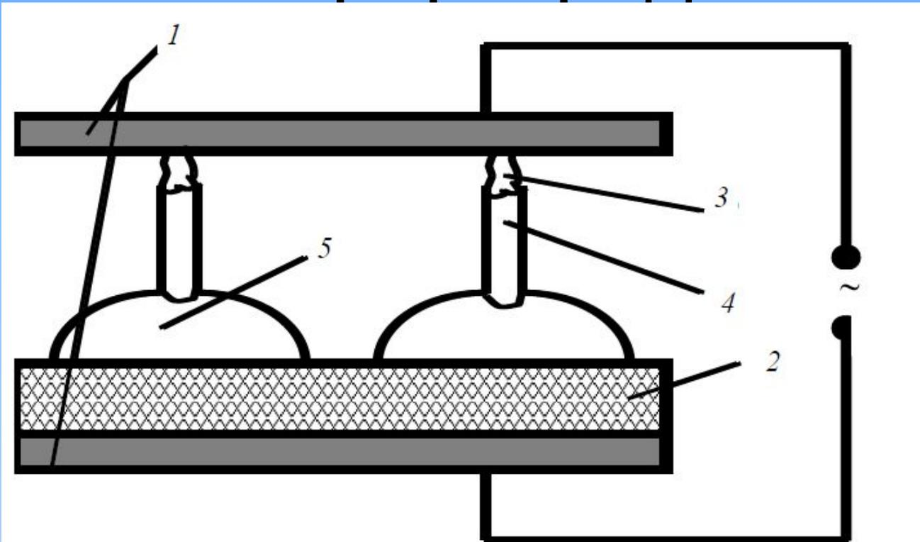
Рис. 1. Фрагмент барьерной разрядной ячейки и геометрия канала микроразряда: 1 — металлические электроды; 2 — диэлектрик (барьер); 3 — приэлектродная часть канала металлического микроразряда; 4 — столб канала микроразряда; 5 — прибарьерная расширенная часть канала микроразряда
