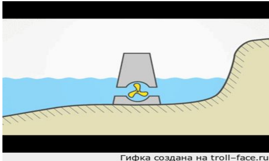
Рис. 10 Схема работы ПЭС
