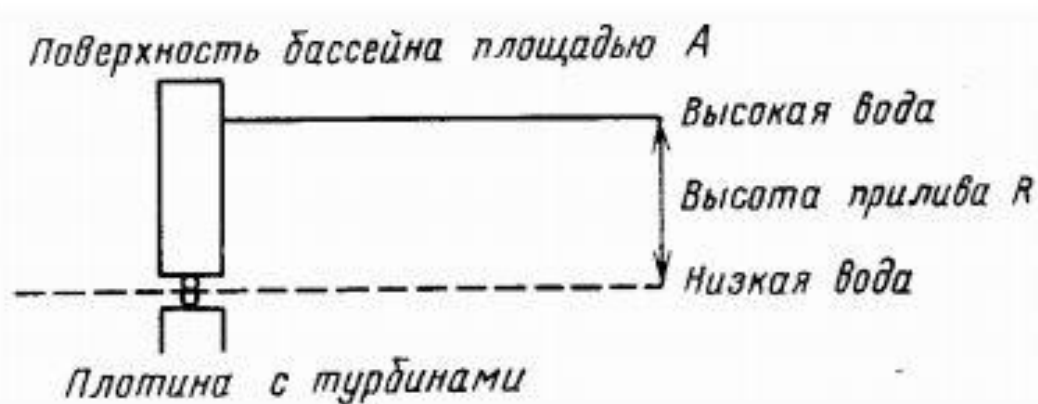
Рис. 32 Схема извлечения приливной энергии
