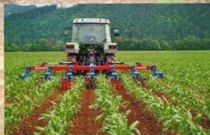
Обработка сахарной свеклы пропашной машиной компании «Хатценбихлер»
