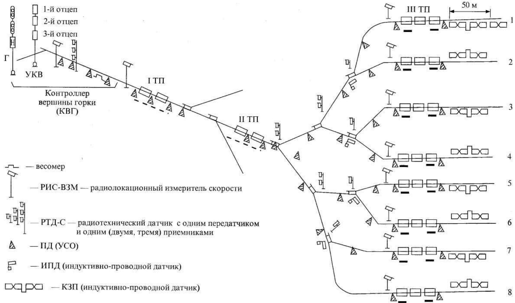
Рис. 5.23. Схема расположения устройств автоматизации на спускной части горки
