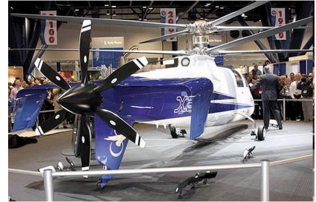
Сверхскоростной легкий вертолет огневой поддержки следующего поколения (Sikorsky): скорость 470 км/ч, вес 2400 кг; лопасти из композитных материалов
