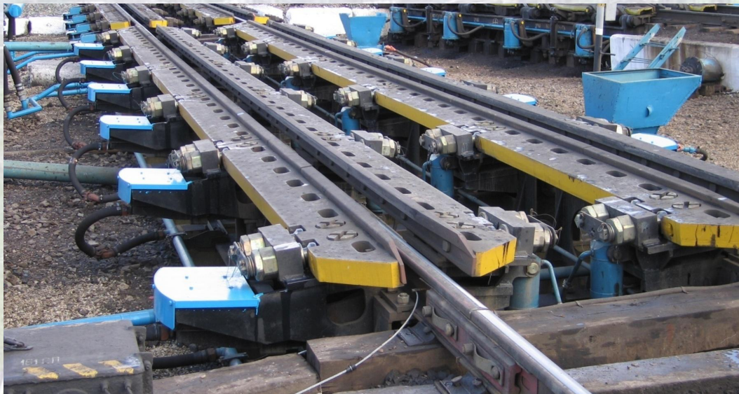
Вагонный замедлитель КЗПУ900-5-2 (горочный, высота до УГР – 900 мм)
