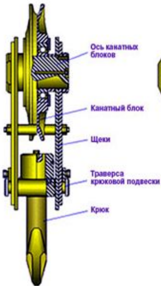
Крюковая подвеска с верхним расположением блоков
