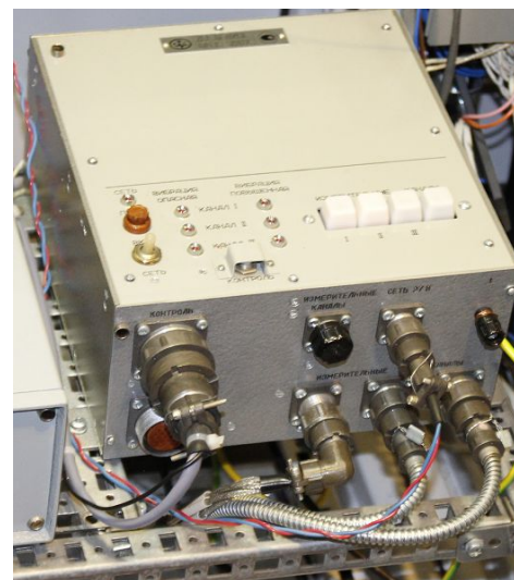
Система контроля вибрации ИВ-Д-ПФ-С-9М ЗАО «Виброприбор», г. Санкт-Петербург
