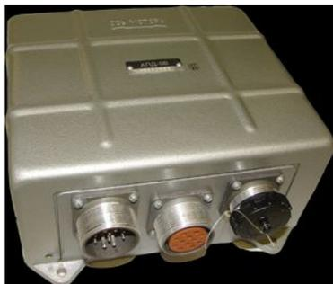
Агрегат регулирования температуры масла
