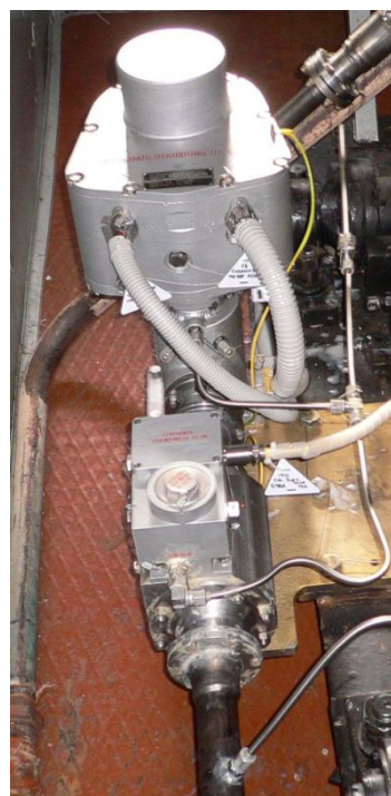
Дозатор газа 816.ДВБ, стопорный клапан 816.СКВБ с блоком управления СУДТ-7
