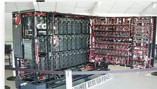
Turing Bombe — электронно-механическая машина расшифровка кода «Энигмы»
