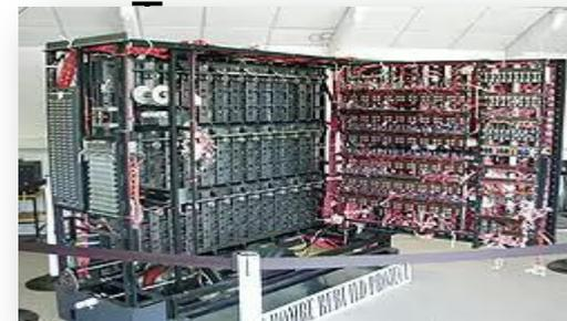
Turing Bombe — электронно-механическая машина расшифровка кода «Энигмы»
