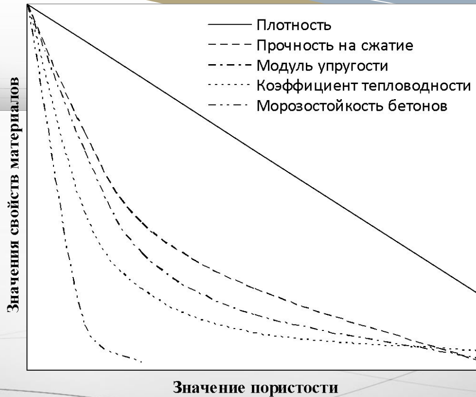
Рис. 6.12. Зависимость свойств материалов от пористости.
