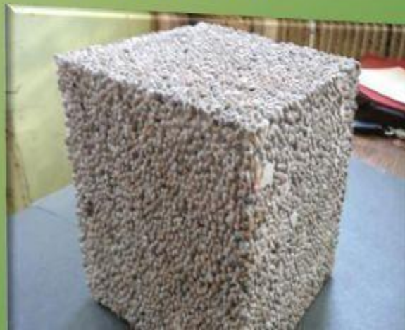
Переработка стекла в пеностекло
