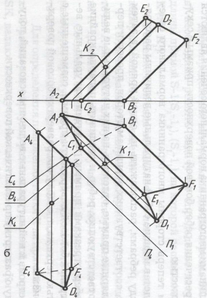
Шаг 3. Пересечем призму в новой системе плоскостей проекций плоскостью  $\alpha$ , перпендикулярной ребрам боковой поверхности и новой плоскости проекции.
