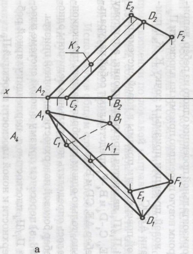
Шаг 1. Воспользовавшись методом замены плоскостей расположим новую ось проекций параллельно горизонтальной проекции одного из ребер и построим новую проекцию призмы на плоскость  $V_1$ .
