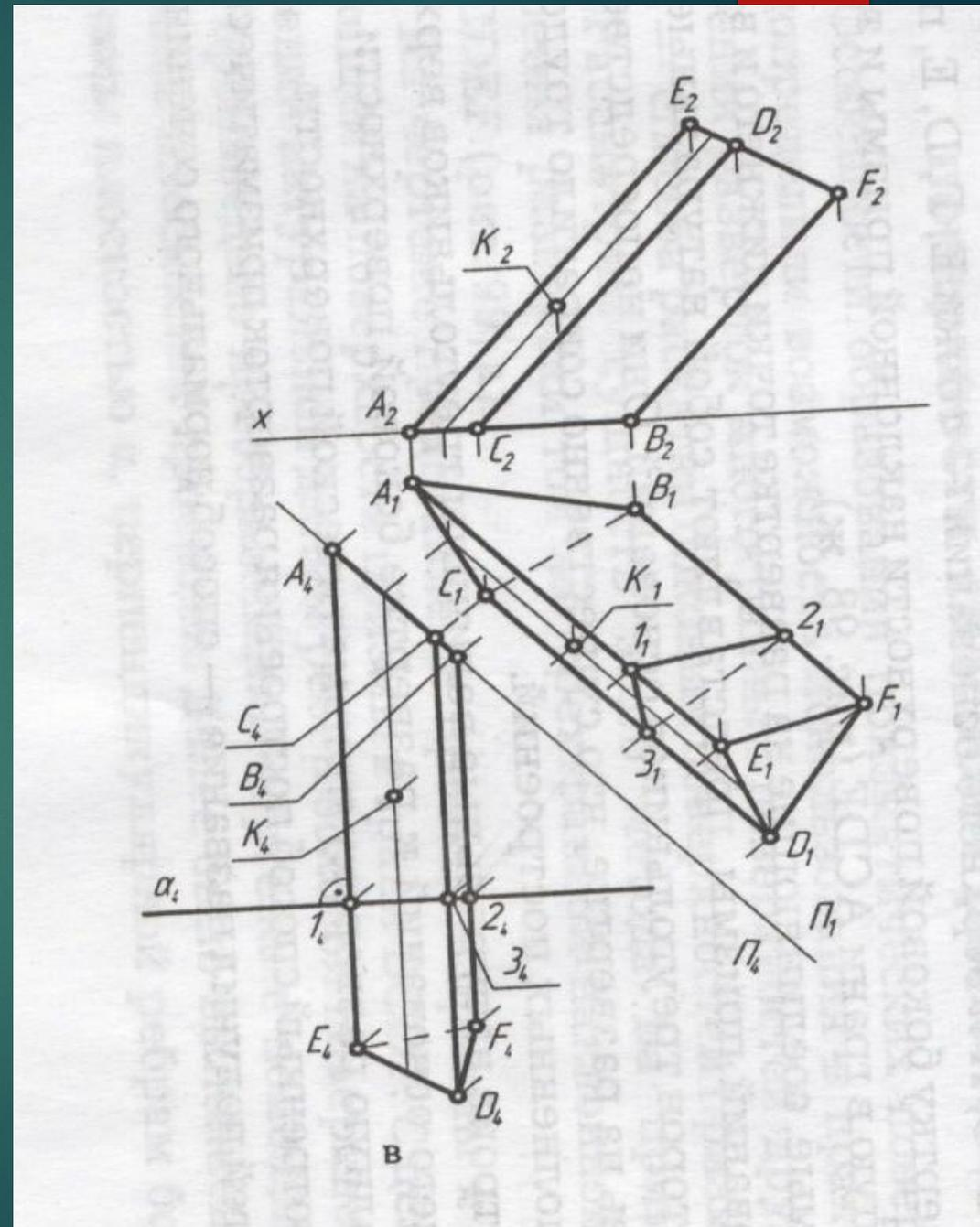
Шаг 4. Продолжим след  $a$  секущей плоскости до пересечения с осью проекции  $H/V1$ .
